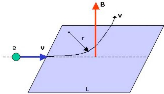
L'accelerazione acquistata dalla particella carica giace nel piano del quadrato ed è, in ogni istante, perpendicolare alla velocità. Si tratta dunque di un'accelerazione centripeta e quindi la particella è soggetta ad una forza centripeta diretta verso il centro di curvatura della traiettoria, il cui modulo è:
