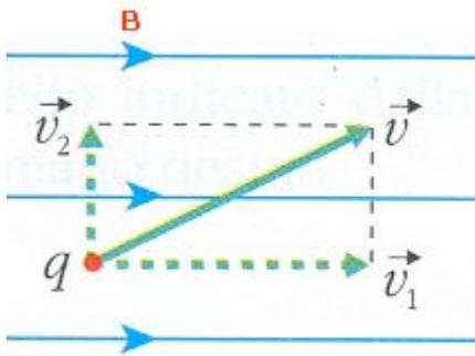
Una particella carica che penetra in un campo di induzione magnetica uniforme  $\mathbf{B}$  con una velocità  $\mathbf{v}$  avente, rispettivamente, componenti  $\mathbf{v}_1$  nella direzione del campo e  $\mathbf{v}_2$  nel piano perpendicolare al campo, descrive una traiettoria elicoidale
