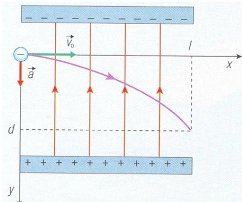
La conoscenza dell'energia cinetica  $E_C$  ci permette di esprimere in funzione di parametri noti il modulo  $V_0$  della velocità iniziale dell'elettrone. Indicando con  $m = 9,109 \cdot 10^{-31} \text{ kg}$  la massa dell'elettrone abbiamo infatti:
