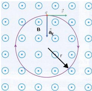
Il corpuscolo carico immesso nel campo magnetico uniforme  $B$  perpendicolarmente alle linee di forza, si muove di moto circolare uniforme nel piano perpendicolare al campo e il valore costante della velocità lungo la traiettoria coincide con la velocità posseduta dalla particella nell'istante in cui entra nel campo.
