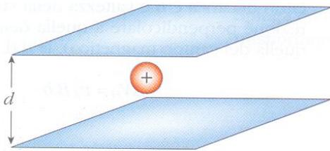
Una gocciolina d'olio di densità  $\rho = 0,822 \text{ g/cm}^3$ , con carica  $q = 6,40 \cdot 10^{-19} \text{ C}$  e raggio  $r = 3,00 \cdot 10^{-5} \text{ cm}$ , viene posta fra due placche distanti fra loro  $d = 5,00 \text{ mm}$ .
