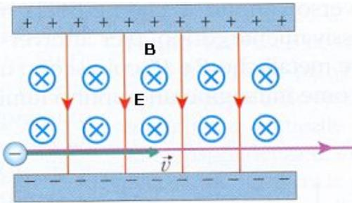
Un separatore di velocità ha un campo di induzione magnetica  $B = 0,01 \text{ T}$  ortogonale a un campo elettrico  $E = 2,0 \cdot 10^4 \text{ V/m}$ .
